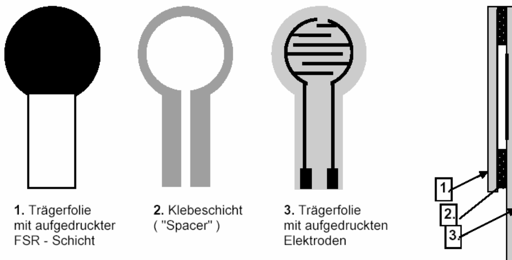
Abb. : Schichten und Aufbau des FSR-Sensors
