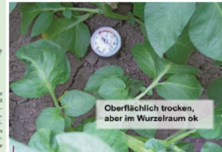
Das Tensiometer zeigt: Oberflächlich ist dieser Boden trocken, aber im Wurzelraum ist die Bodenfeuchte richtig.
